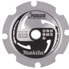
Ein extra-starkes Makita Faserzement-Sägeblatt mit Polykristallin-Diamant Zähne. Dieses Kreissägeblatt wurde speziell zum Sägen von Faserzementplatten entwickelt. Die Zähne sind flach und mit einer zusätzlichen Schicht aus polykristallinem Diamant (PCD) besetzt. PCD ist ein Verbund aus Diamantpartikeln und Metallbinder.
