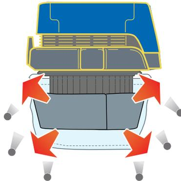
Sobald der Staubsauger ausgeschaltet ist, kehrt der Schaumstofffilter in den Original-Zustand zurück. Die angehäuften Staubpartikel fallen in den Behälter, der Vorfilter ist wieder sauber und bereit für den nächsten Einsatz.
