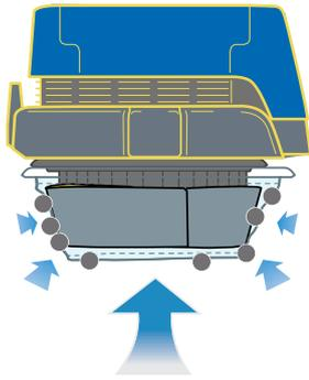
Beim Einschalten des Staubsaugers wird der Vorfilter über den Schaumstoff und Feinfilter angesaugt.
